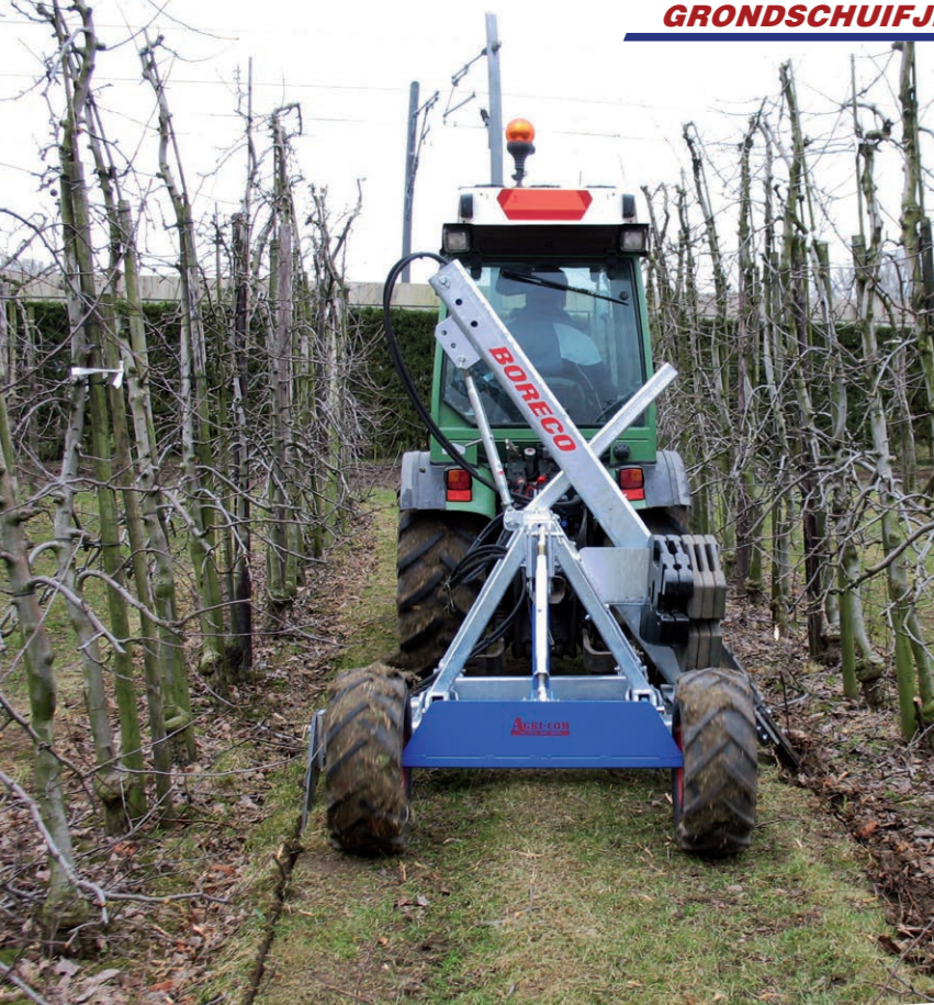
Het standaard rechte mes op de achterbalk wordt gebruikt in de "slepende" stand om de machine in balans te houden.
