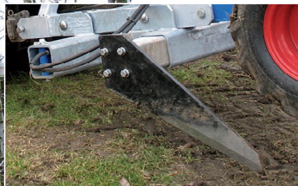
Het standaard rechte mes op de achterbalk wordt gebruikt in de "slepende" stand om de machine in balans te houden.
